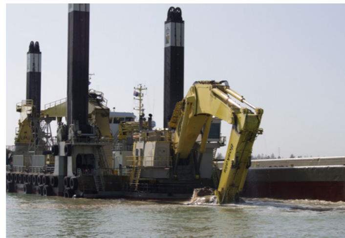
Backhoe Dredge 'Magnor'
